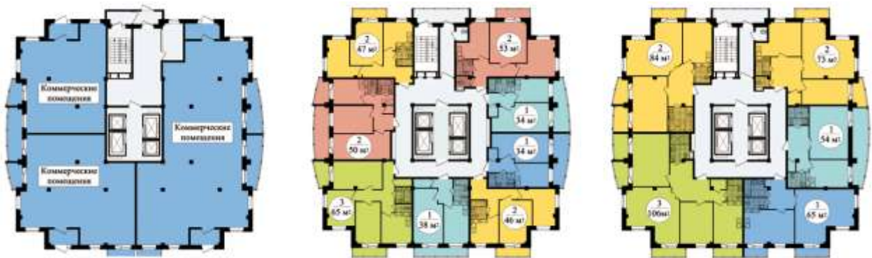
Рисунок 23 – Планировочные решения этажей жилого и нежилого назначения здания по системе «КУБ-2,5»
