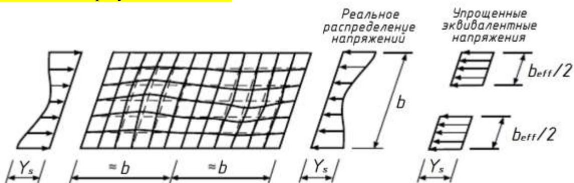
Рисунок 2.3 - Концепция эффективной ширины применительно к пластине
