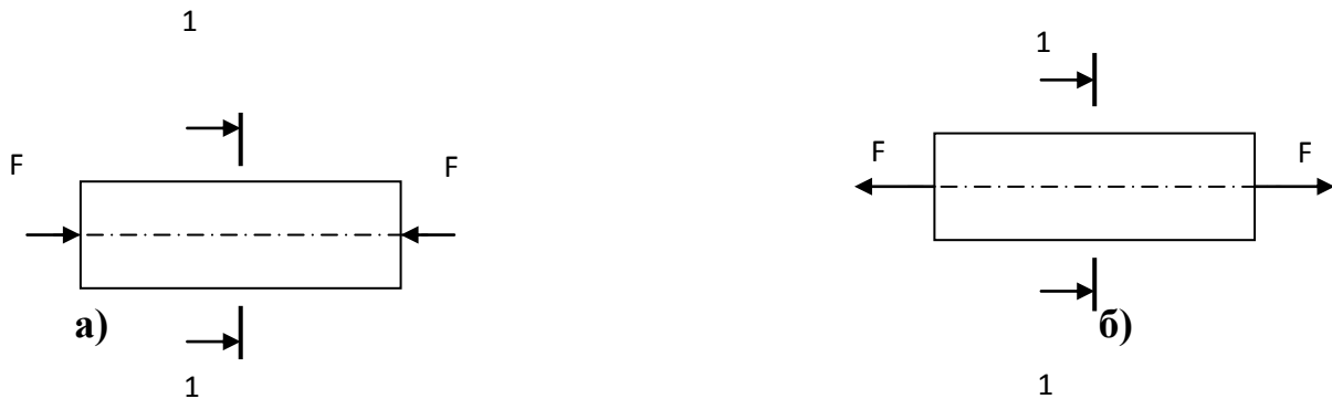
Рис. 2.1 – Деформация стержня: а) сжатие; б) растяжение
